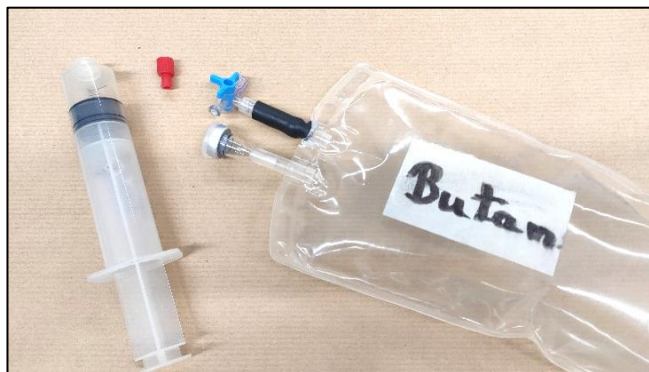
Abbildung 5: Foto dreiteilige Luer-Lock-Spritze, Universal-Verschlusskappe, Gasbeutel mit Dreiwegehahn. (IQB e. V., 2024).
