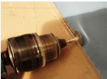
Abbildung 12: Die Seite wird mit einer Trennscheibe ausgeschnitten. (IQB e. V., 2024).
