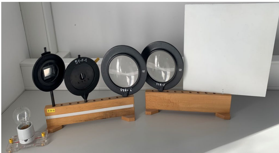
Abb. 4: Lampe, Doppelspalt, Spalt, zwei Linsen und Schirm, IQB
