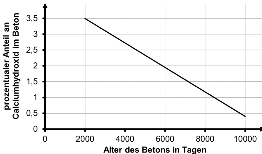
Abb. 4: zeitabhängige Entwicklung des Mindestanteils an Calciumhydroxid in Beton nach der Aushärtezeit
